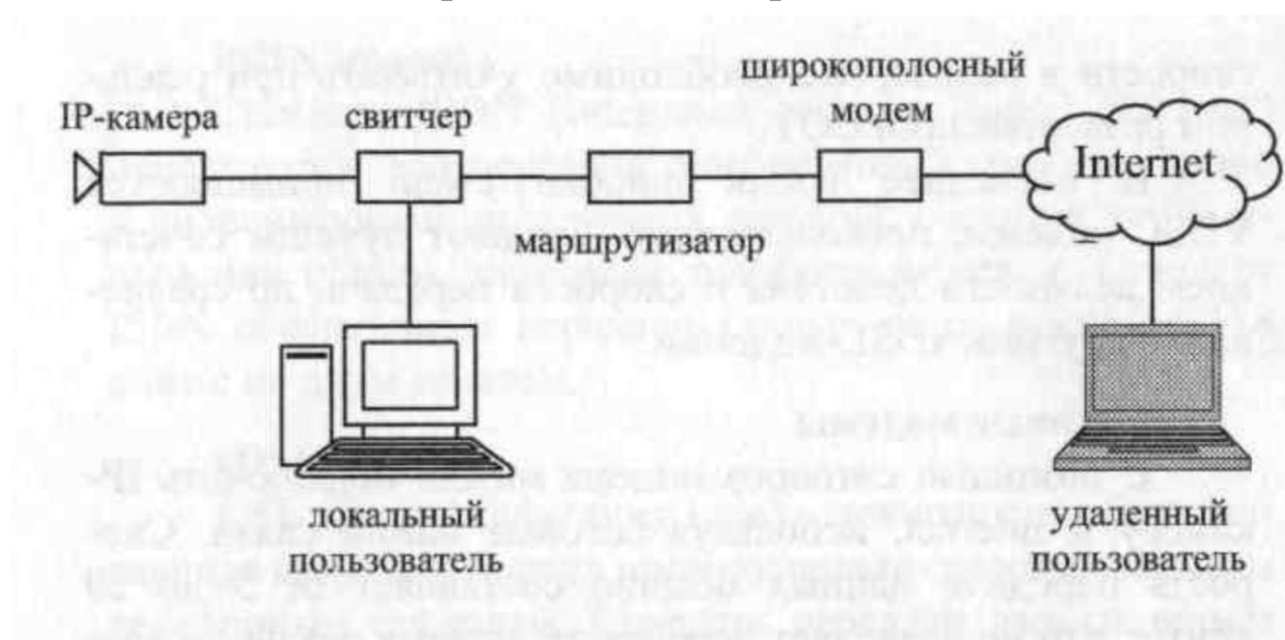
Рис. 11 - Схема работы IP-камер в локальной сети
