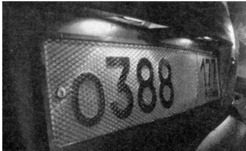
Рис. П9 - Нанесение специальной сетки на номер для дезориентации СОТ
